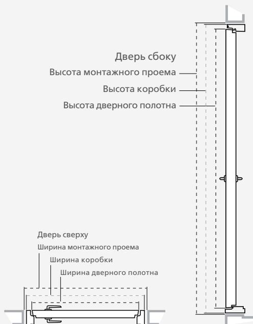
Входные двери JELD-WEN можно заказать, согласно приведенных в таблице размеров. Перед заказом нужно замерить размер дверного проема. При замере необходимо учесть монтажный зазор 10 – 20 мм. ПРИМЕР: Для двери М10 x 21 – размеры дверного проема будут 1010 мм x 2100 мм.
